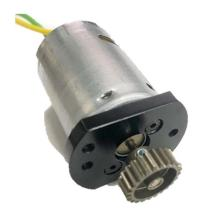
変換アダプターの切り欠きの部分にピニオンギヤ固定用のイモネジ (別売)が来るように位置を合わせてピニオンギヤをシャフトに固定します。
