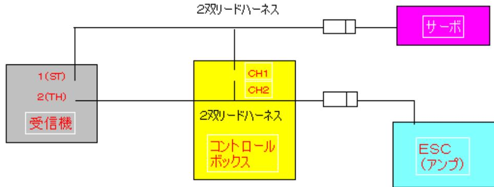
1. コントロールボックスのCH1に付属の2双リードハーネスを接続し、ステアリングサーボと受信機のCH1 (ST) に接続してください。
