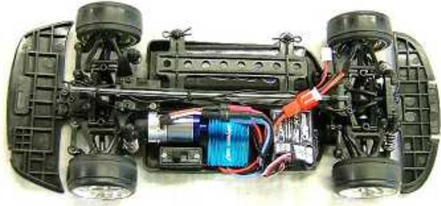
ブラシレス・アンプのコネクターを受信機のスロット2に差し込んでください。コネクターには向きがありますので、注意してください。スロット1のサーボと同じ配色の向きで差し込んでください。ブラシレスモーターとアンプの3本を以下の通りに接続してください。 赤+赤 黒+黒 青+白
