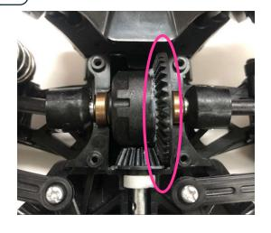
フロントのデフギヤを逆転させます。 リングギヤを図の向きになるようにしてください。
