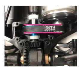
ベルトとプーリーが水平になるように組み込みます。 ベルトの張り具合も調整してください。
