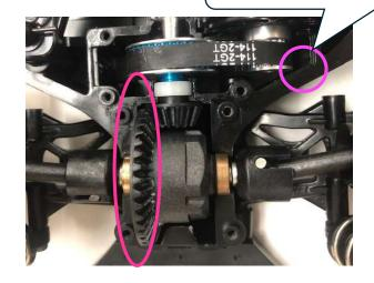
リヤのデフギヤを逆転させます。 リングギヤを図の向きになるようにしてください。
