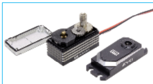
オールアルミ製のサーボケースは、高い耐久性と モーターの放熱性に優れます。 サーボギヤはフルメタル使用。
