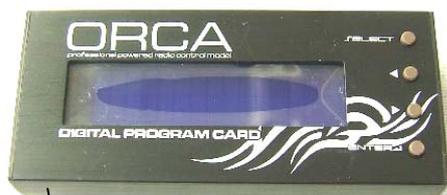
アンプのあらゆる特性をセッティングする液晶ディスプレイ付きデジタルプログラムカードが付属します。
