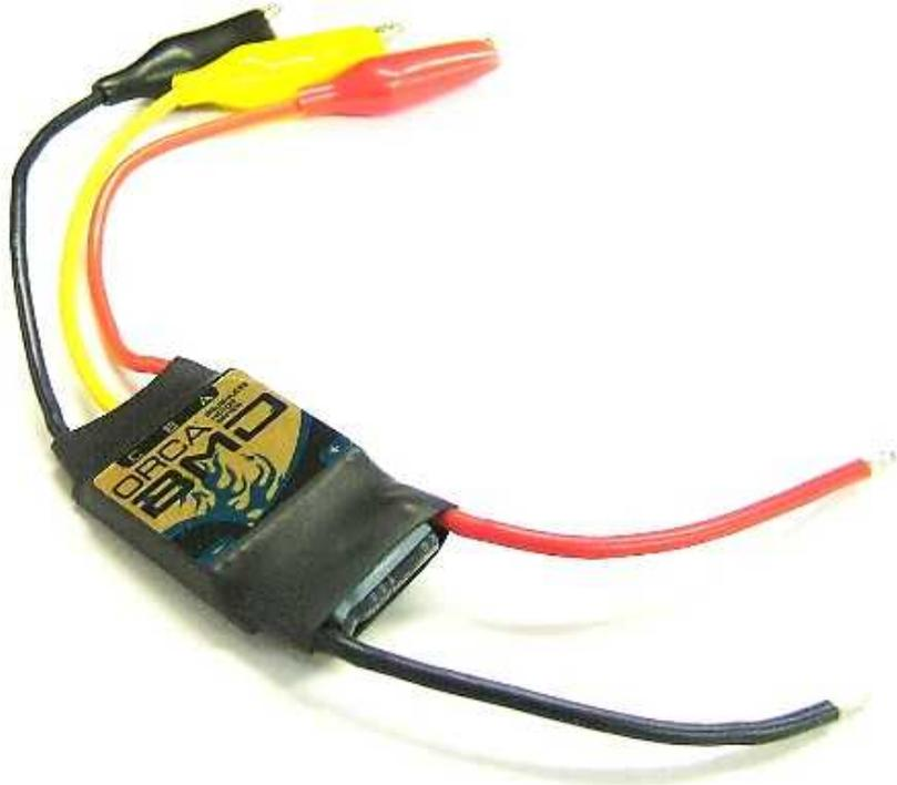
マッチモアやオリオン等のブラシモーター用モーターチェッカーに接続することで、ブラシレスモーターの性能をチェック出来るブラシレス専用モーター・ドライバーです。シビアなレースシーンで、ブラシレスモーターの性能チェックに欠かせない便利アイテムです。
