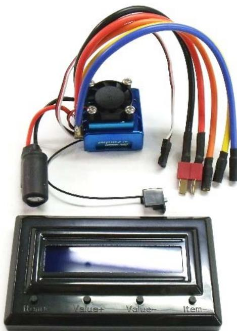
センサー付きブラシレスモーター対応の「サプライズ S ブラシレス・シリーズ」に、ハイエンドユーザー向けの大容量タイプが新登場！標準装備のセッティングカードで、ターボやブースト機能を含む 17 項目にも及ぶきめ細やかな調整が可能なので、走行状況に応じたセッティングが施せます。ツーリングカー、ドリフトカー、オフロードカー、オンロードカー、Mシャーシなどの様々なジャンルのラジコンカーにお使いいただけます。
