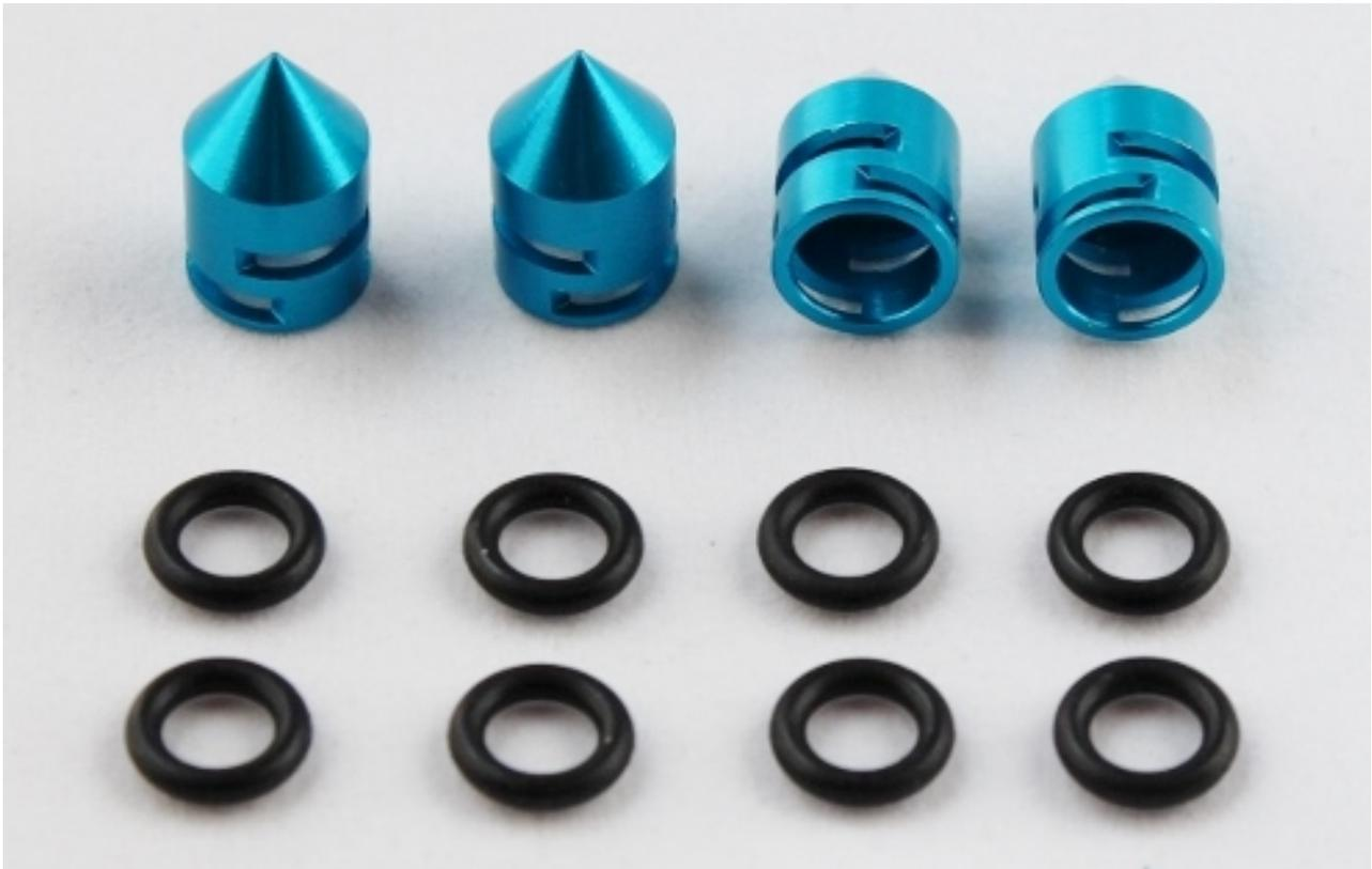
完成済みボディや塗装後のボディマウント用の穴あけの位置決めに便利なアルミ製のマーカです。ボディマウントにマーカを装着し、ボディ側のホイールアーチとシャーシ側タイヤの位置決めをして、ボディを軽く押さえれば、ボディにマウント用の穴位置がマークされます。
