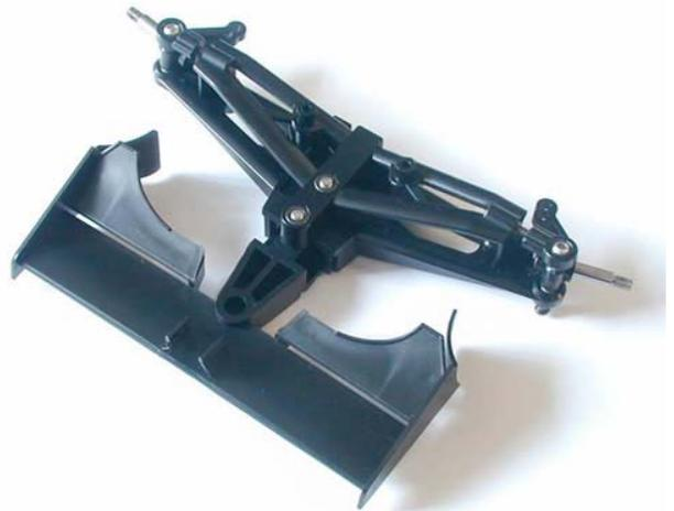
ラジコンF1メーカーの雄、クロスとOPTION No. 1が共同企画した高性能F1シャーシです。車体は工場完成済みですので、R/Cメカ、モーターを載せてボディを塗装すれば、すぐに走行できます。メインシャーシとアッパーデッキには、実車F1マシンのモノコックにも採用されている軽量、高剛性のカーボン材を使用。見た目のカッコよさと高性能の両立を実現！フロントサスペンションには、オプション設定だった強化タイプが標準装備。ターンバックル式で、容易にフロントタイヤのキャンバー角が調整できます。90年代初頭のF1シーンを沸かせた赤い跳ね馬をイメージしたFタイプボディが付属。(ステッカーは付属しません。)アルミオイルダンパー標準装備。フルボールベアリング仕様。7段階の車高調整が可能なアルミモーターマウント標準装備。
